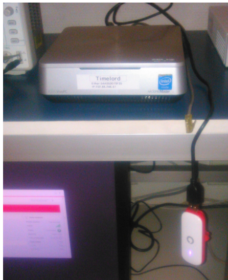
1.2. ábra. A végberendezés funkcióját a Timelord mini PC és a hozzá kapcsolódó LTE USB modem megvalósítja meg
